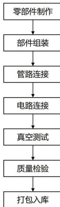
图 3-2 循环水式多用真空泵工艺流程图
